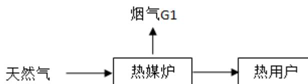
图 5-1 技改工程燃气锅炉供热工艺流程图
