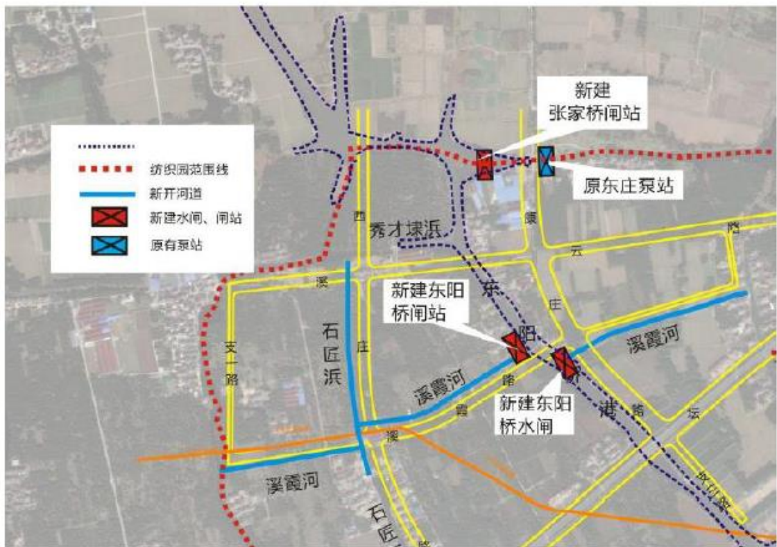
图 6.2-16 近期拟新建闸站水闸示意图
